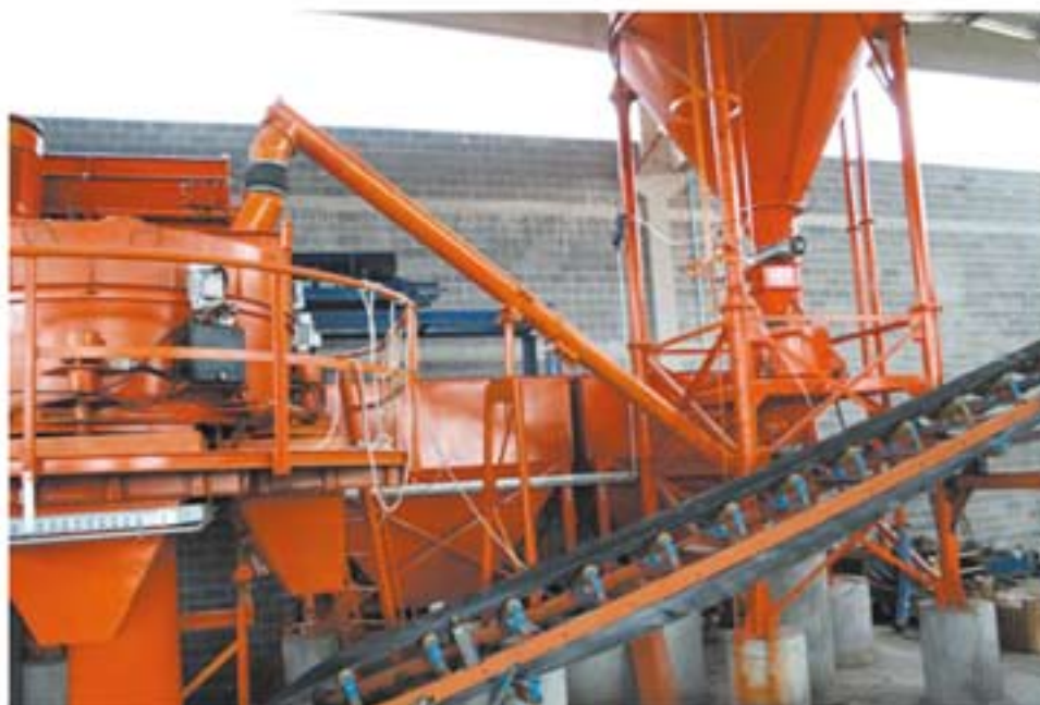
FIGURA 8.8 - Usina de concreto com misturador planetário de eixo vertical
