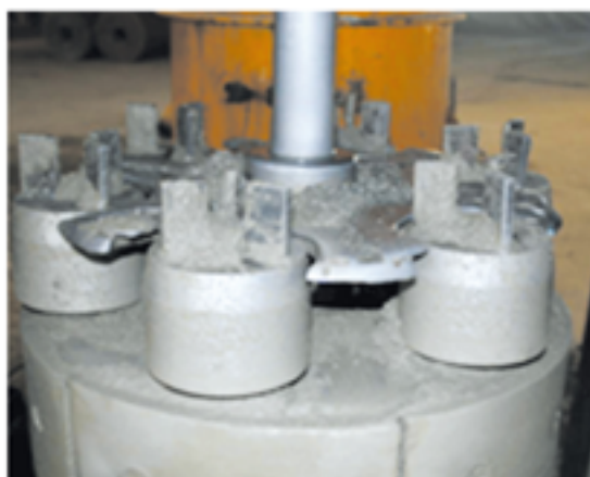
FIGURA 8.1 - Êmbolo simples e roletes para adensamento radial
